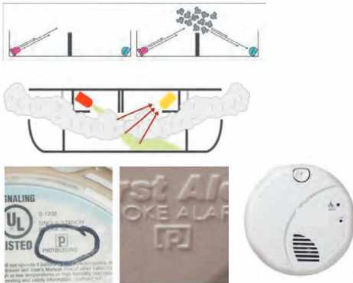
شکل ۳۲ - عملکرد دتکتور دودی و علامت مشخصه آن
