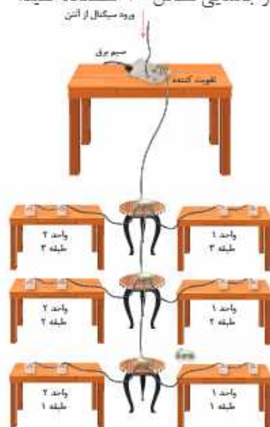
شکل ۴۰- چانمایی قطعات آنتن مرکزی در محیط کارگاه
