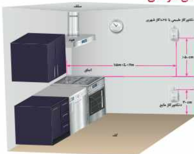
شکل ۵۱ - فواصل نصب دتکتور گاز در آشپزخانه یک ساختمان مسکونی
