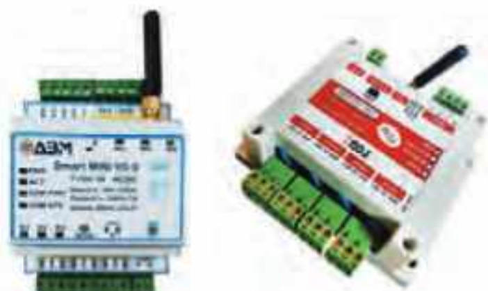
شکل ۱۶- سامانه کنترل از راه دور با پیامک
