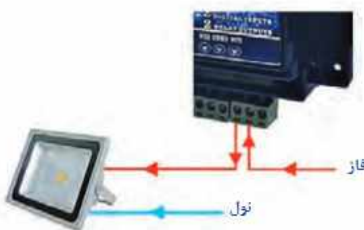
شکل ۲۰- نحوه کنترل دستگاه برقی
