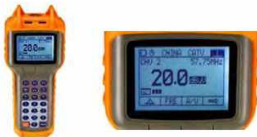
شکل ۲۴- اندازه‌گیری سیگنال خروجی آنتن توسط سیگنال سنج
