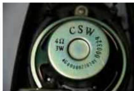
شکل ۹- توان بلندگو و امپدانس
