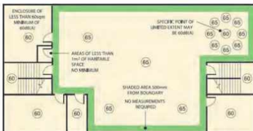
شکل ۶- شدت صوت هشدار دهنده در فضاهای مختلف
