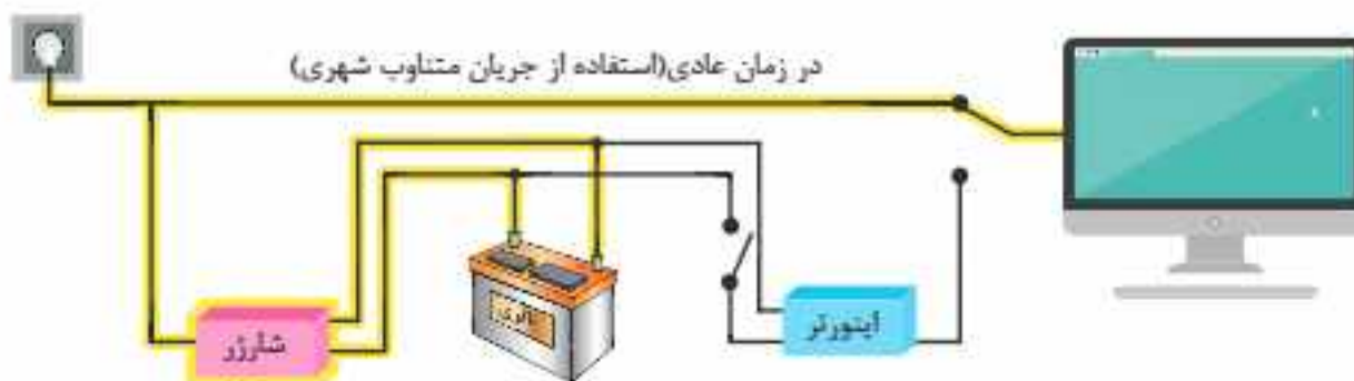
شکل ۶- حالت شارژ باتری
