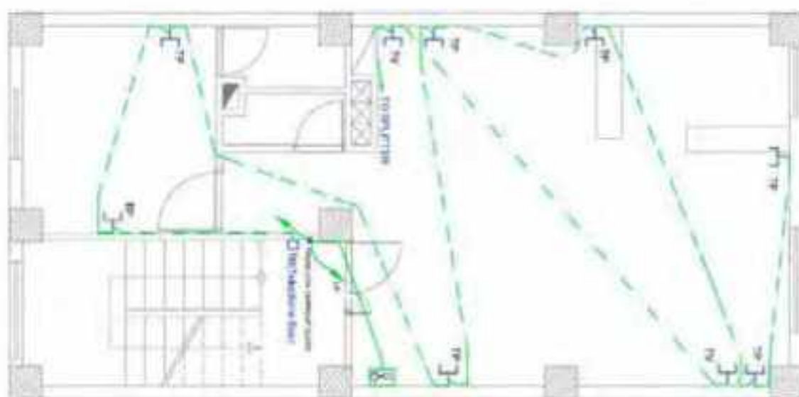
شکل ۱۰ - نقشه سیم‌کشی پریز تلفن و پریز آنتن
