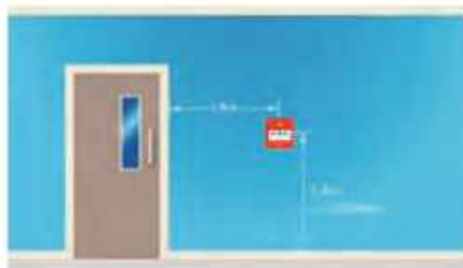
شکل ۲۱- محل و ارتفاع نصب شستی
