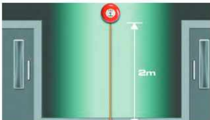
شکل ۵- ارتفاع نصب آژیر
