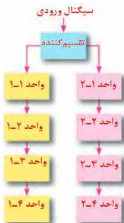
شکل ۳۰- مدار آنتن مرکزی در یک ساختمان ۴ طبقه
