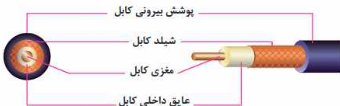
شکل ۷- اجزاء کابل کوآکسیال RG59
