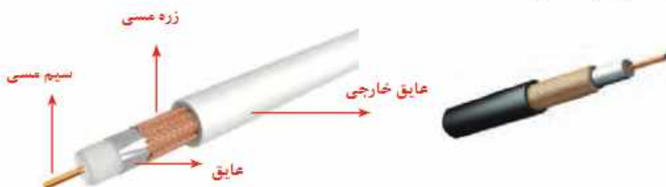
شکل ۲۶- کابل کواکسیال
