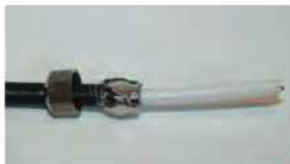
۴- یرگ های گیره را مطابق شکل روی پوسته خارجی کابل جمع کنید.
